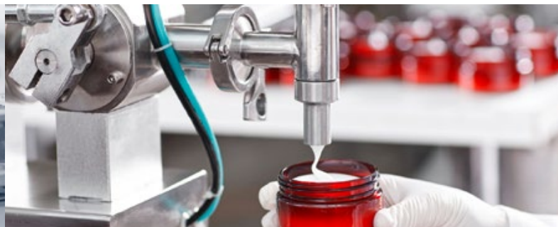
Производство косметики — установка для розлива кремов
